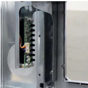
Cellules photoélectriques de reconnaissance des gobelets jusqu'à 3 hauteurs différentes
